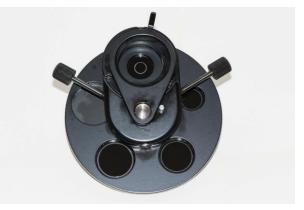
Der Kondensor MFA-2 ist zur Verwendung mit Phasenkontrastobjektiven bestimmt. Er kann jedoch an normalen Objektiven zur Erzeugung von variablem Dunkelfeld genutzt werden.
