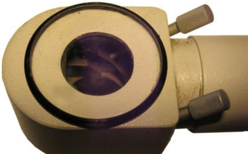
Ansicht von Unten. Zum Öffnen des Gehäuses müssen die Beiden Schrauben entfernt werden.
