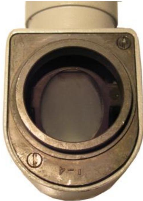
Vorsicht! Die Feder übt einen recht starken Druck aus, daher die Bodenplatte gegendrücken, damit die Schrauben nicht ausreißen.
