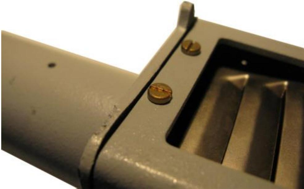
Hier bietet es sich an, die vorhandenen Befestigungsschrauben gegen Ersatzfüße auszutauschen. Ideal sind hier Stehbolzen aus dem PC-Bereich, auf die dann Gummipuffer aufgesteckt werden.
