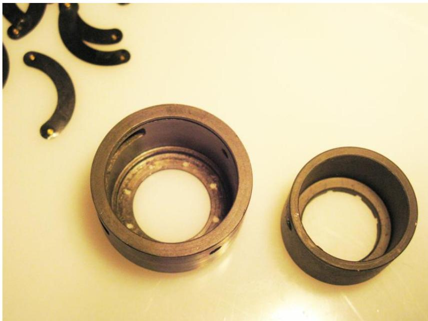
Sine keine neuen Lamellen zur Hand, müssen die vorhandenen Lamellen mit Versatz eingebaut werden; d.h. es dürfen niemals zwei Lamellen nacheinander fehlen.
