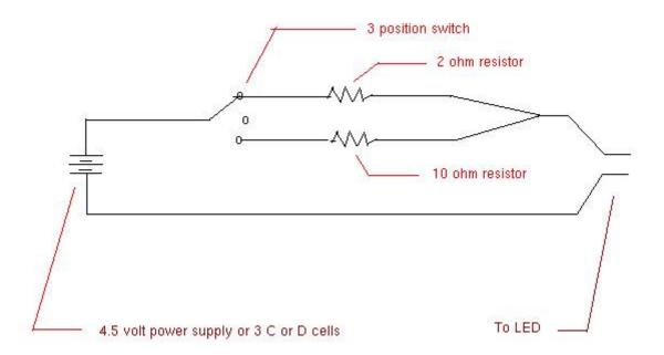
Elektronik- und Elektro-Läden verkaufen in der Regel 4,5-Volt-Stromversorgungen. Für eine 3 Watt Star LED wird dies eine, die mindestens 700mA liefert erfordern.
