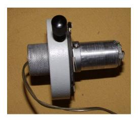
Bohren Sie zwei Löcher für 3mm Schrauben am oberen Ende der 22,95 Millimeter, die genau in die Schlitze an der LED passen. Ein schmaler Schlitz muss für den gleichen Zweck entsprechend dem Schlitz in der LED, für die Drähte eingesägt werden.
