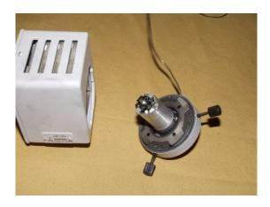
Löten Sie sorgfältig die Drähte an die LED. Ziehen Sie die Drähte durch das bearbeitete Stück, und schrauben sie mit den 3mm Kunststoffschrauben die LED fest. Eventuell müssen Sie die Kanten der Schrauben nach dem Anziehen abfeilen, so dass der Beleuchter in die Steckdose passt. \*(Siehe unten, Verwendung von Metallschrauben.)
