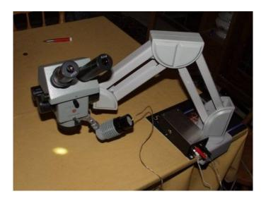
Der normale MBS-10 Illuminator kann unter dem Tisch für Durchlicht-Beleuchtung platziert werden, oder in einer speziellen Overhead Halterung zur Beleuchtung von oben. Zum Glück ist das Lampengehäuse von ziemlich guter Qualität, im Gegensatz zu der Qualität der Glühbirnen und elektrischen Teile.
