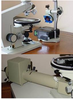
Die beiden häufigsten verwendeten Optionen. Ein einfacher Dual-Aufbau für Mikrofotografie mit der OI-19 unten OI-35
