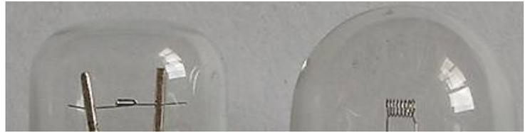
Seitenansicht von links, Philips 13347W Glühbirne und rechts, die typischerweise gelieferte Russische Lampe. Man sieht den flacheren Glühfaden und die flachere Glashülle des Philips.
