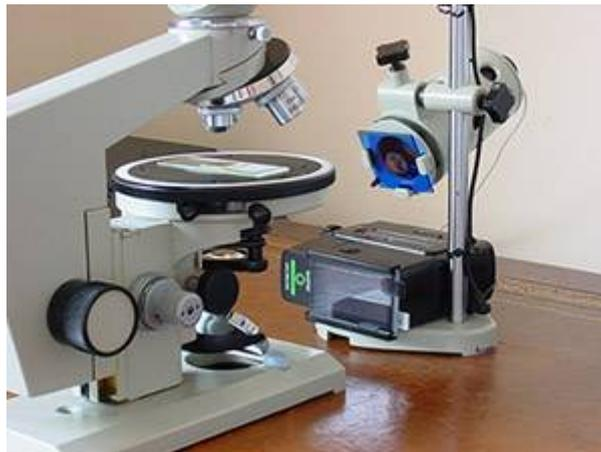
*OI-19 Lampe; eine einfache, aber effektive Beleuchtung für den schnellen Umstieg auf Blitz für Mikrophotographie.*
