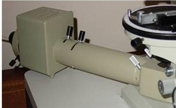
*Iris und Fokuskondensator im Rohr. Interner Spiegel verstellbar mit Schrauben für Glühfaden-Ausrichtung. Glaskolben zentrierbar an der Rückseite des Gehäuses der Glühbirne.*
