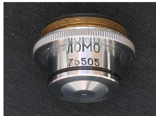
20x0,80 160/0 Apochromat Ölimmersion, für Fluoreszenz geeignet, vorgesehen für die Kontrolle von Korngrößen in Gelatinefilm (Fototechnik)
