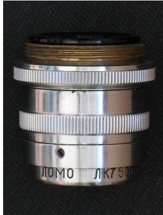
**95x1,25 190/0 Achromat Ölimmersion, für Fluoreszenz geeignet, für Tubuslänge 190mm berechnet. Gewindegröße M27**
