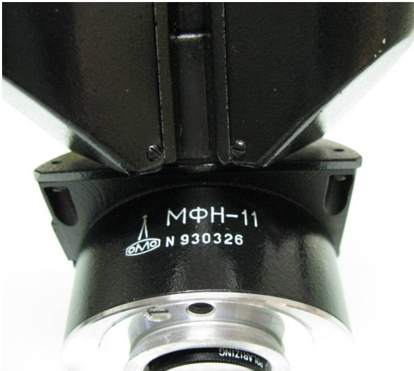
Der LOMO-Trinokulartubus MΦH-11 unten im Bild die abgebrochene Zugstange für das Umschaltprisma
