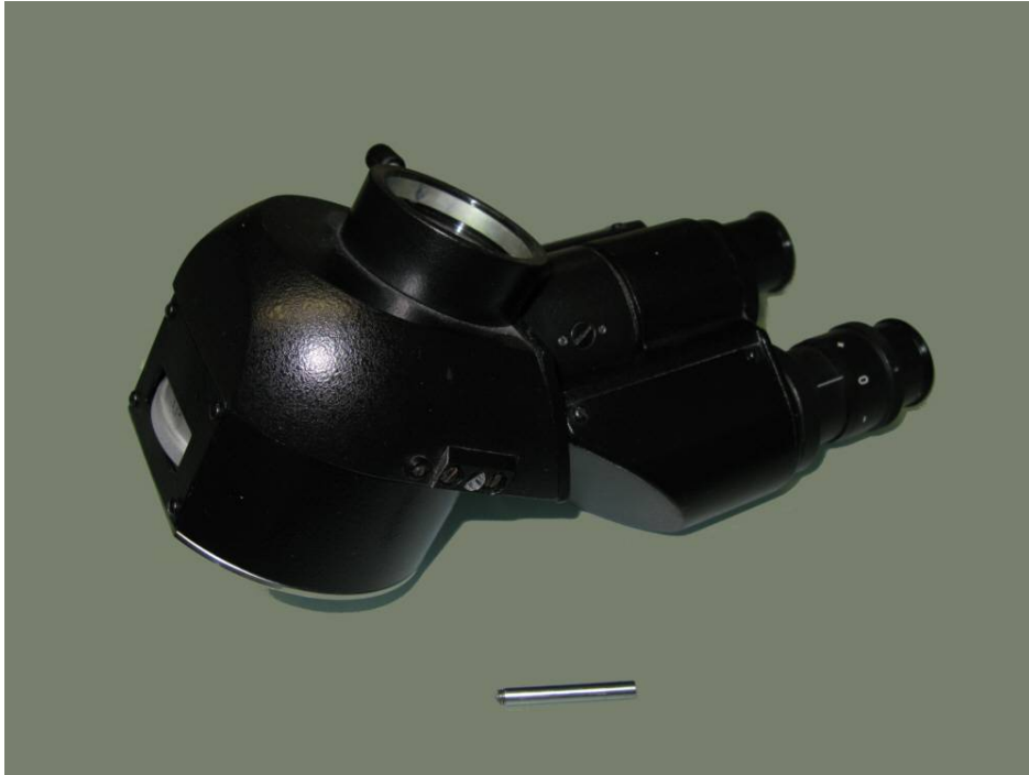
Der LOMO-Trinokulartubus MΦH-11 unten im Bild die abgebrochene Zugstange für das Umschaltprisma
