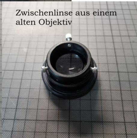
Kameraadapter bestehend aus M42 Komponenten
