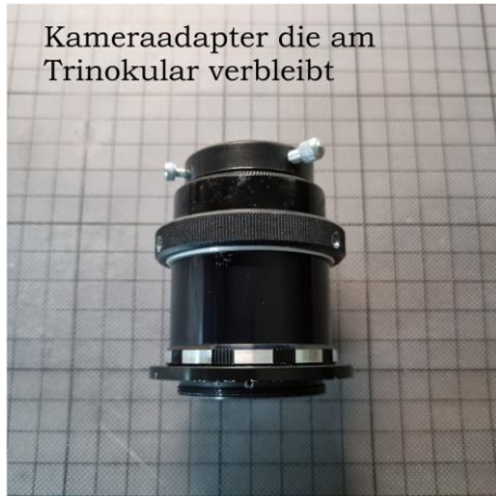
Kameraadapter bestehend aus M42 Komponenten
