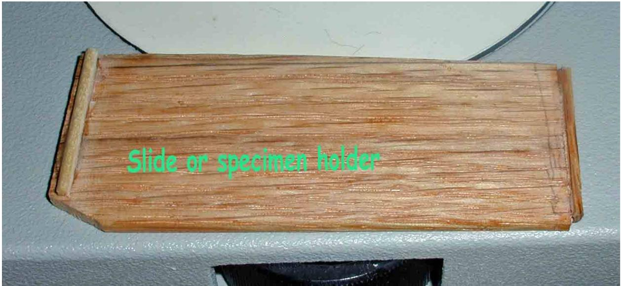
Der Objektträger sollte leicht in den Träger passen. Sie benötigen den Träger, da ein Objektträger gelegentlich unter den Federkraftklemmen auf dem Mechanismus durchrutscht. Der Eichenträger ist dick genug, dass dies nicht passieren kann. Hier ist der Aufbau.
