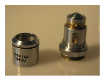
Wenn das Ganze, wie erwartet bombenfest sitzt, muss man den Rändelring mit einer Wasserpumpenzange festhalten, (die Hülse jedoch nicht; die ist einfach zu dünn! Hier benutzt man ein Klempnerwerkzeug [kleine Siphonzange, oder Perlatorzange]. Diese Zangen haben kunststoffgeschütze Backen) und dann die Hülse vorsichtig abdrehen.
